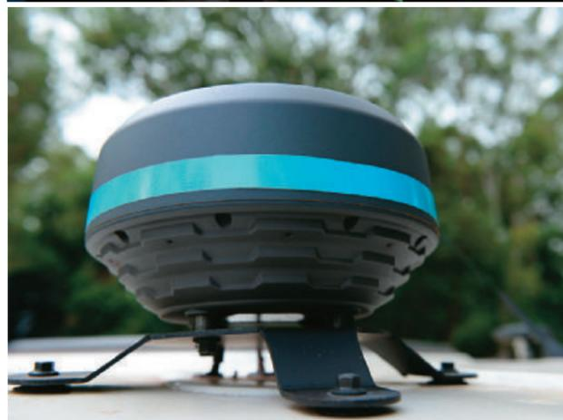
此次的合作，是在VOLVO垃圾清運車安裝最先進的自動駕駛科技，可持續監視周圍環境，如果道路上突然出現障礙物，車輛就會自動停止。如果是首次在新區域使用自動駕駛垃圾清運車時，系統會先要求手動駕駛，此時車載自動駕駛系統就會利用感應器、GPS衛星導航等技術，連續監控與描繪路線；當第二次來到相同區域時，就能完全接手駕駛任務，照著既定路線前進，該走就走，該轉彎就轉彎，該在哪個垃圾箱前停下來，精準無誤，完全照辦。
