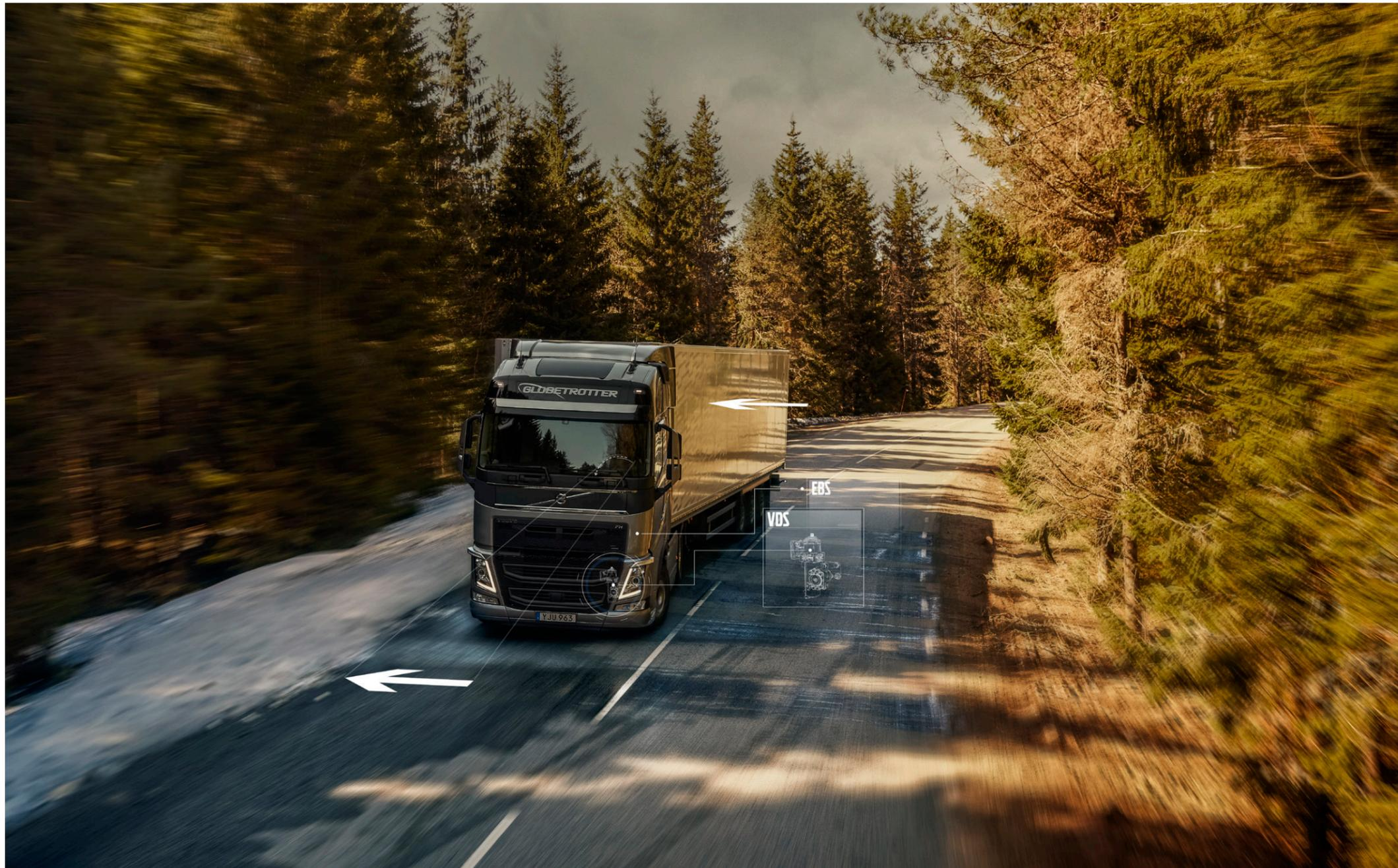
反方向轉向，藉以讓車尾找回循跡性。在過去，這必須仰賴駕駛的多年經驗、對車輛動態的熟悉度以及當下的反應，但現在有了VDS，系統可在駕駛尚未察覺、車尾打滑現象發生之初，就主動介入修正，預先防止打滑意外的發生。
